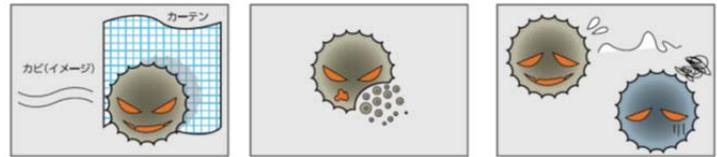
空気中の浮遊菌がカーテン上の薬剤に触れると、菌の最も外側の細胞壁が破壊されて生育できない状態になり、その間、同種菌に対して危険信号を送ります。危険信号が伝達された同種菌は近寄らなくなり、カビの生成が抑制されます。
